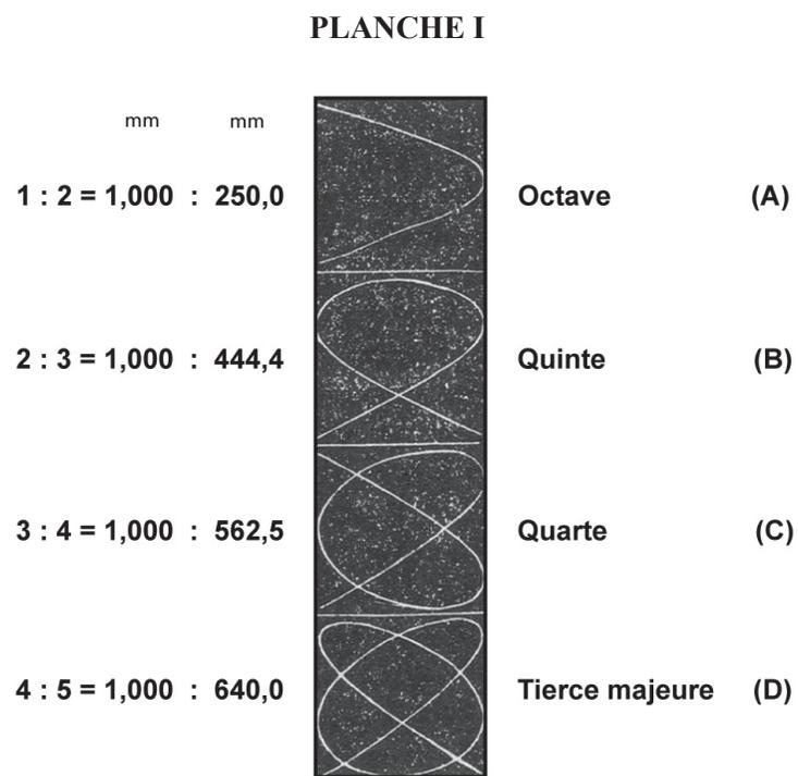
La planche I montre les intervalles musicaux obtenus par l'oscillation d'un pendule double<sup>3</sup>, au bout duquel est placé un entonnoir en verre rempli de sable fin. La longueur relative de chacune des tiges retenant les masses peut être modifiée.
