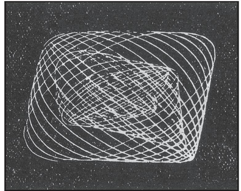
Le tracé de la planche IV a été obtenu par une modification de la longueur relative des tiges d'un pendule double de façon à obtenir des intervalles musicaux.
